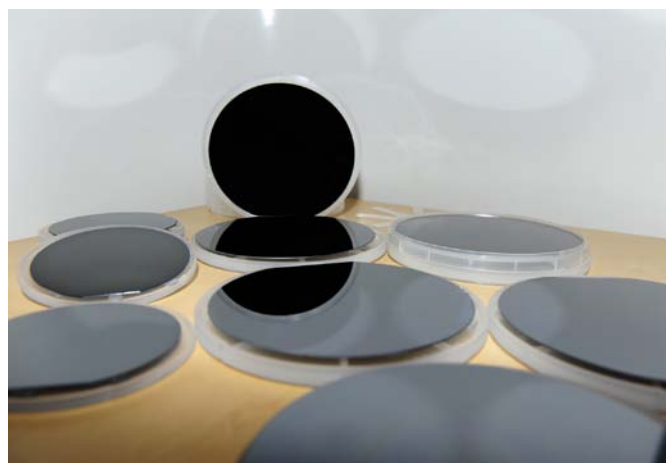
图1：EpiGaN外延晶圆硅基氮化镓4英寸和150mm晶圆直径
